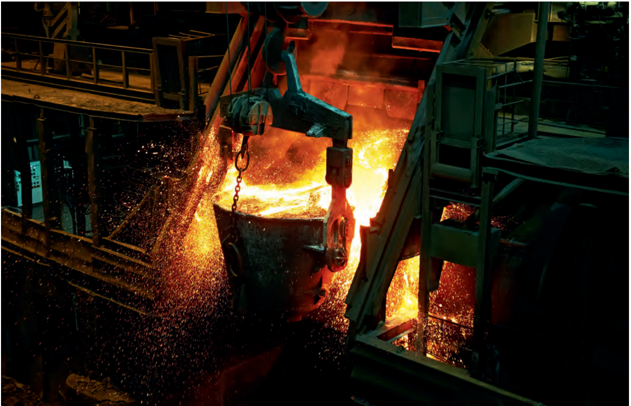
Beschickung des Konverters mit Kupferstein.
